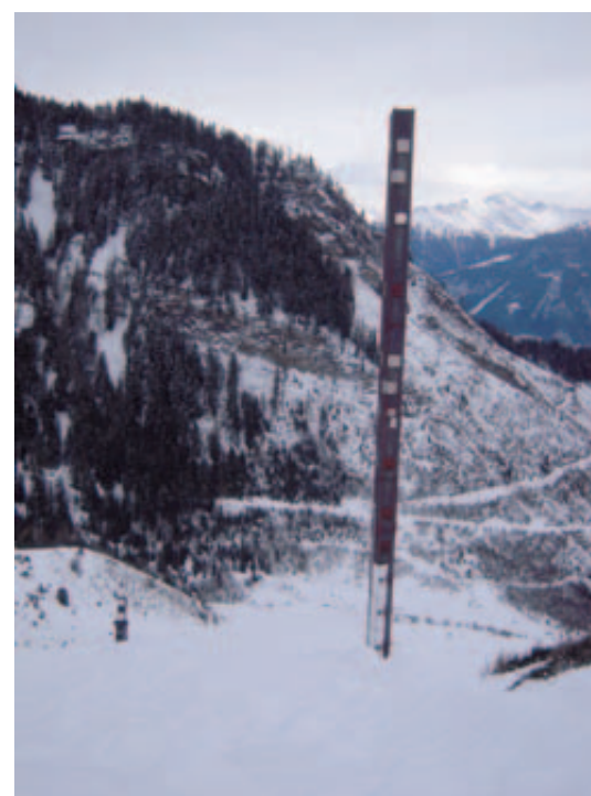
Des obstacles comme ce mât truffé de capteurs de vitesse, de pression, de densité et de force sont répartis le long du parcours de l'avalanche. PHOTO SLF
